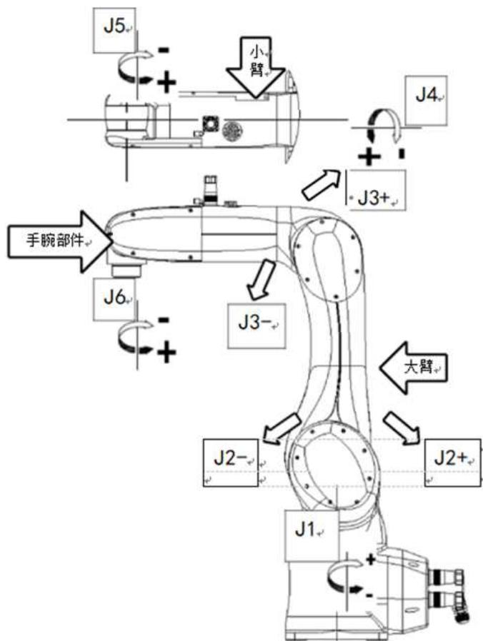
图 2-2-1 机器人机械系统组成图
