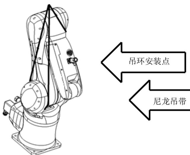
图 5-2-2 吊带使用方法
