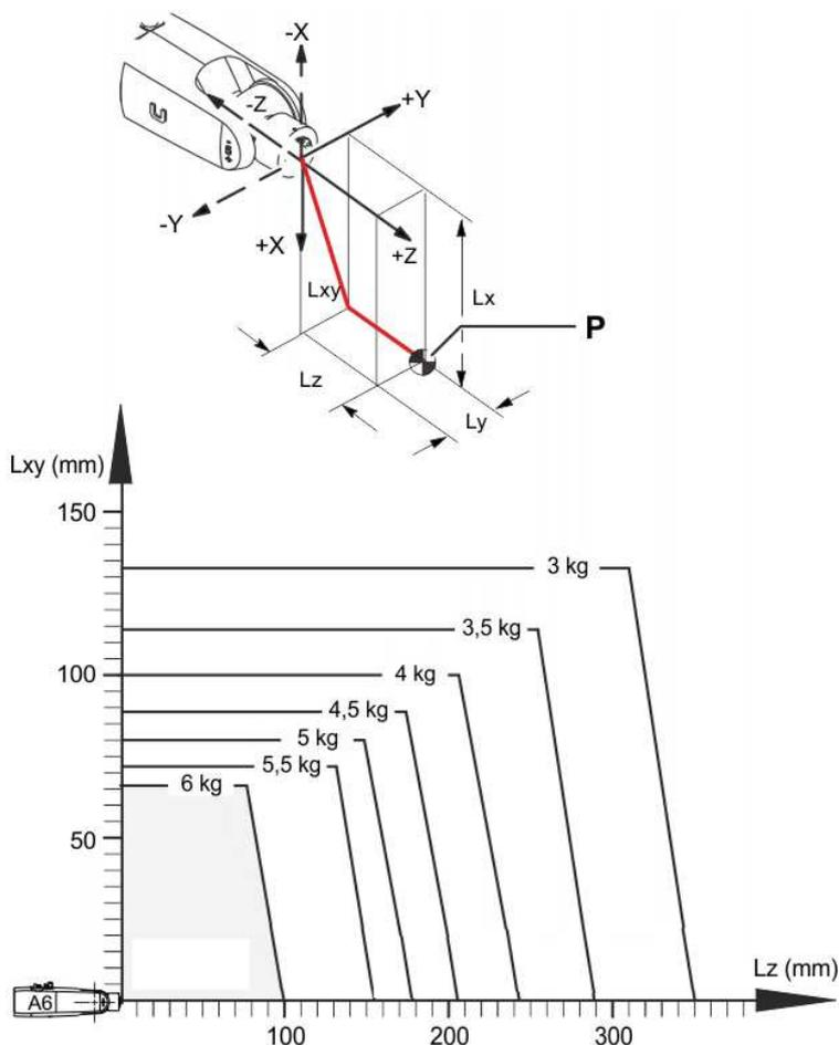
RB06-900 搬运机器人手腕轴扭矩图，使用时负荷重心点应在手腕扭矩图范围之内。
